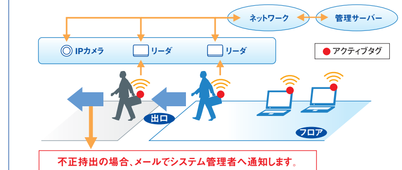
図1 RFIDを活用した持ち出し管理システムの概要
